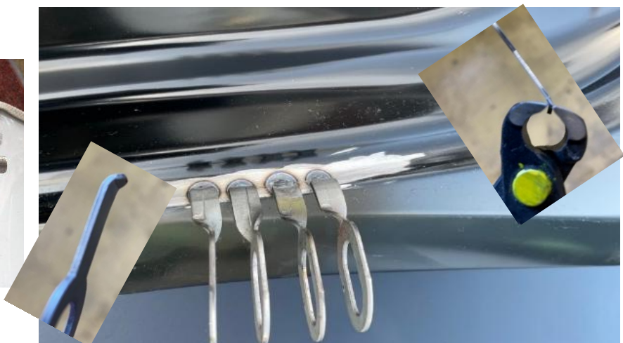
Falzkanten ziehen ohne Lochbildung
