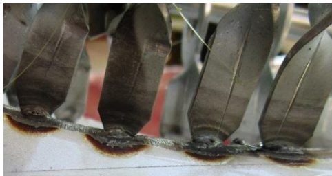
Bit eingeschweisst (Pulsschweissung)
